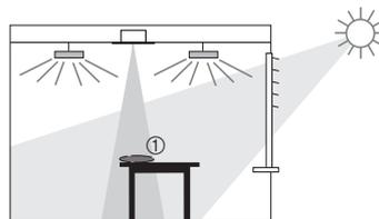
$$\text{Romkorrigeringsfaktor} = \frac{\text{Lysstyrkeverdi i taket}}{\text{Lysstyrkeverdi på arbeidsflaten}}$$
